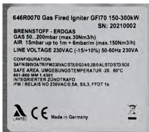
Fig. 3-3 Exemplo de placa de características do queimador de ignição GFI da LAMTEC
