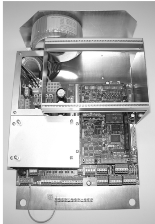
Fig. 3-4 LT2 típusú lambda transzmitter szerelőpanelre 173 x 310 x 270 mm (ma. x szé. x mé.), típus: 657R103-...
