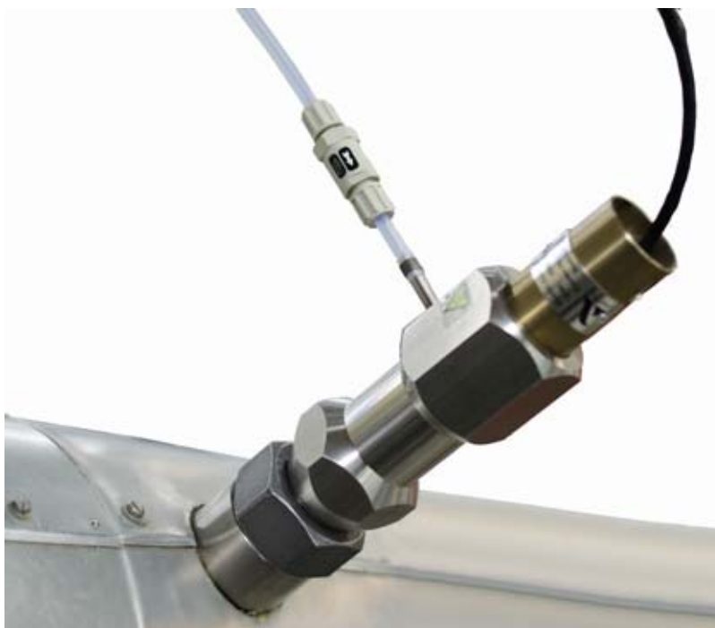
Fig. 5-3 Dispositivo de teste introduzido no canal de gás de exaustão
