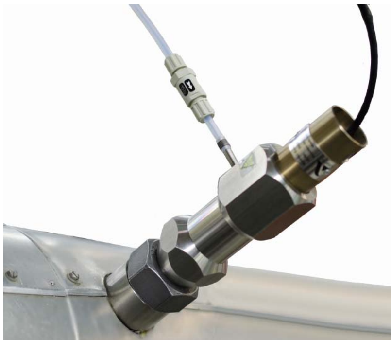
Fig. 5-3 Testanordningen instucken i avgaskanalen
