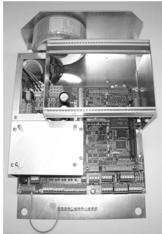
Fig. 3-4 Lambdalähetin LT2 asennuslevyllä 173 x 310 x 270 mm (K x L x S) tyyppi 657R103-...
