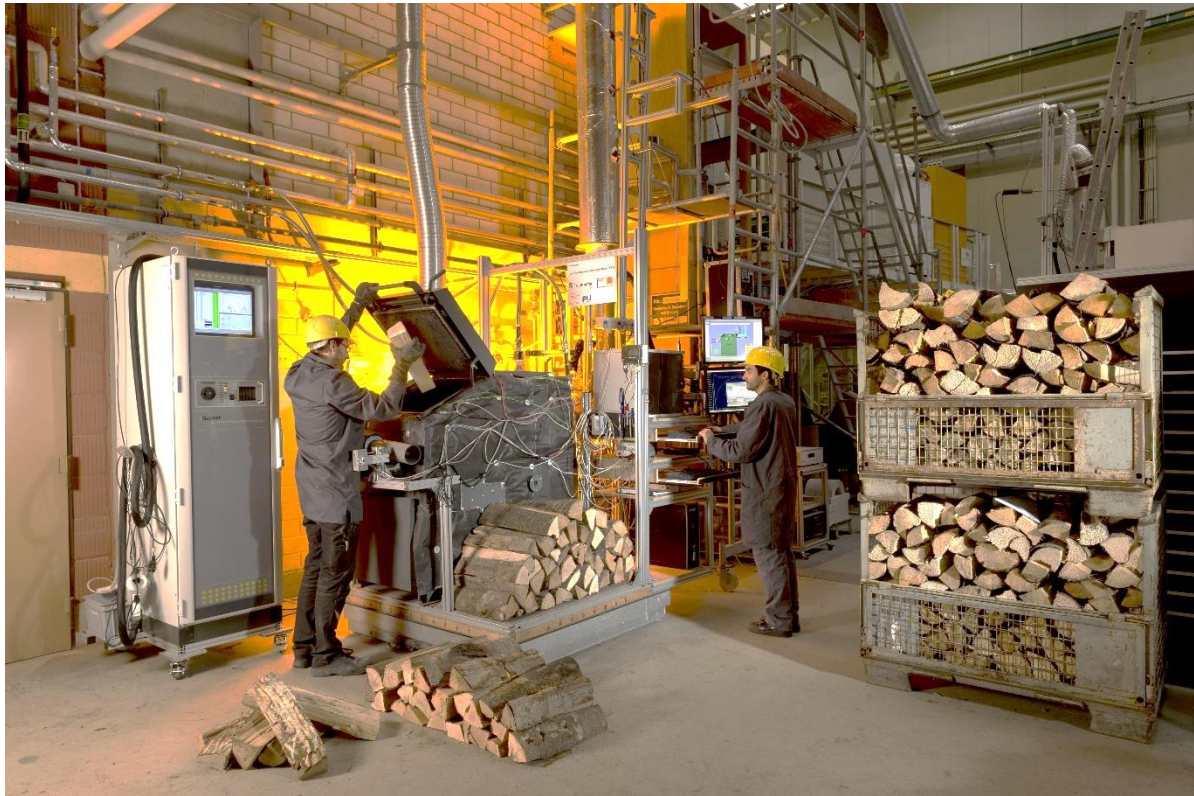
Abbildung 8: Technische Einrichtung (akkreditierter Prüfstand gemäß DIN EN 304 für die Zulassungsprüfung von Heizkesseln gemäß DIN EN 303-5) für die Versuchsdurchführung und Entwicklung des VREM-Systems.
