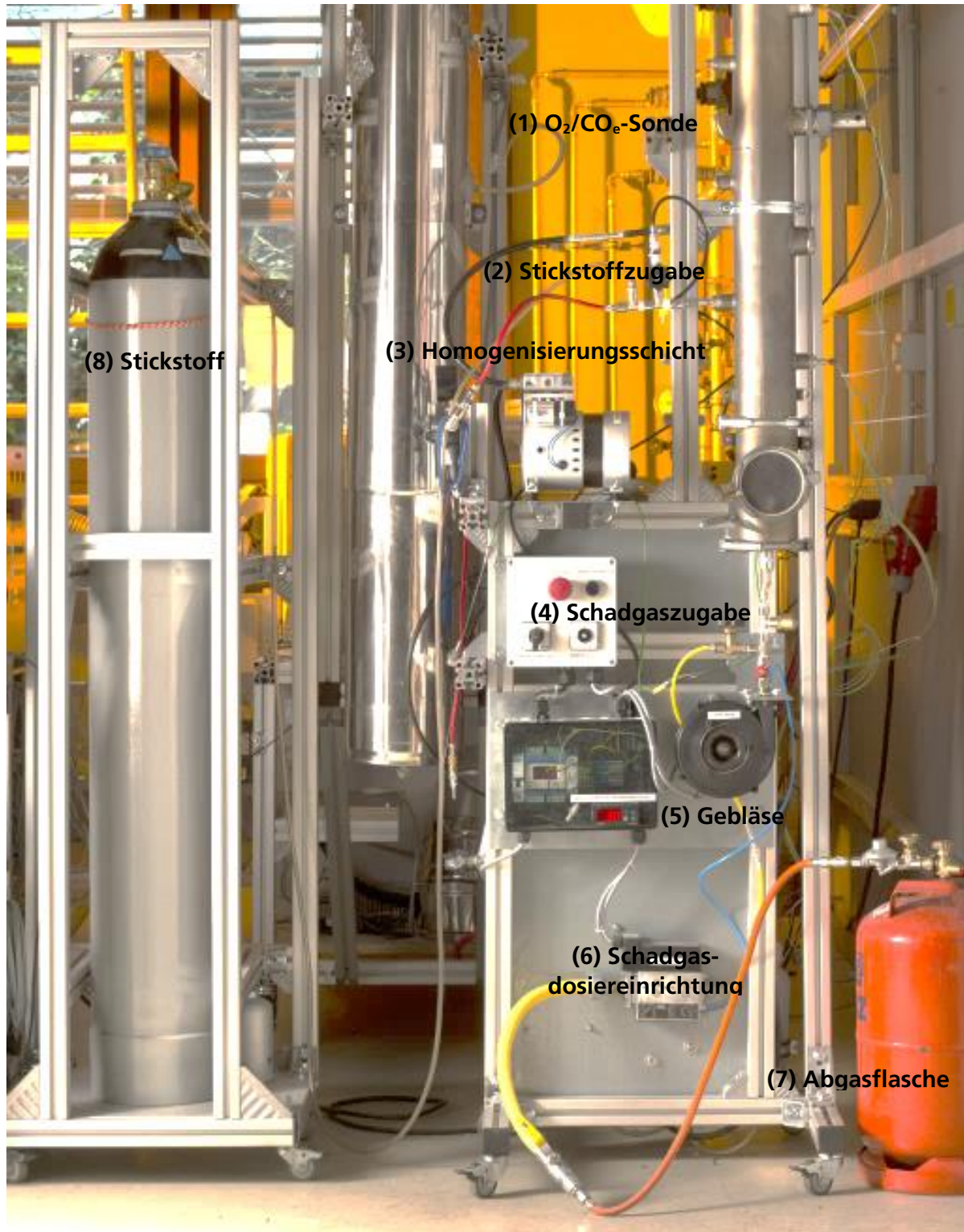
Abbildung 7: Versuchsaufbau zur Kalibrierung und Charakterisierung der \text{O}_2/\text{CO}_e -Sonde.
