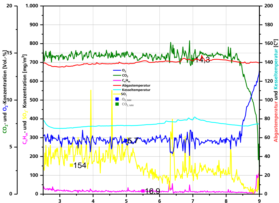
Diagramm 11: Schwefeldioxid bei der Verbrennung von Traubentrestern im LEVS-System (zweistufige Verbrennung) des Fraunhofer IBP.
