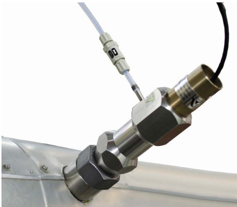
Fig. 7-2 Zkušební pomůcka vsunutá do spalínového kanálu
