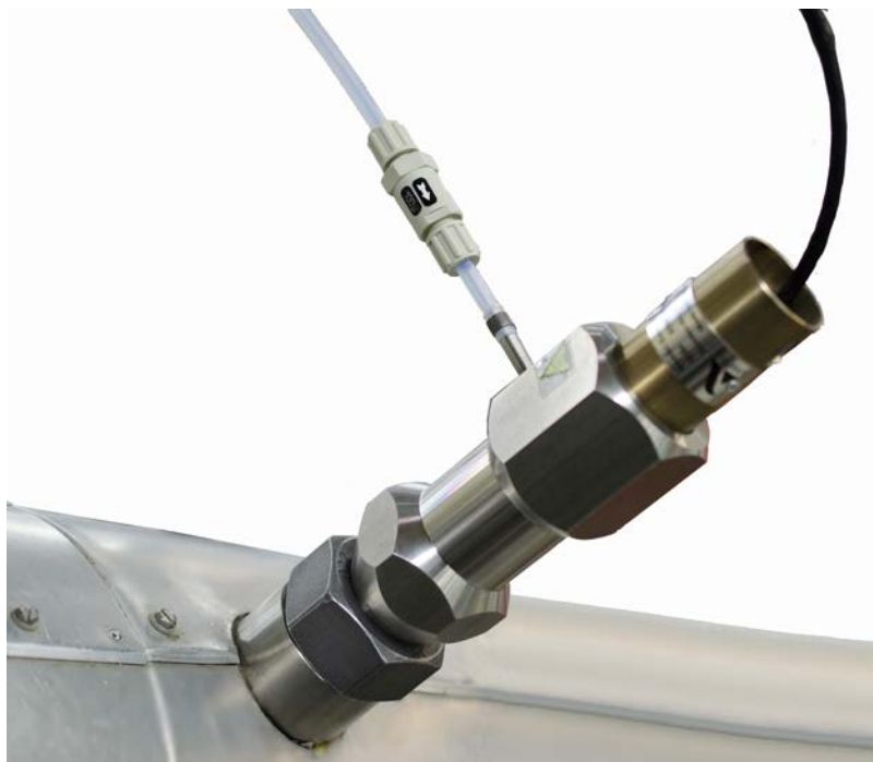
Fig. 5-3 Przyrząd kontrolny włożony do kanału spalinowego
