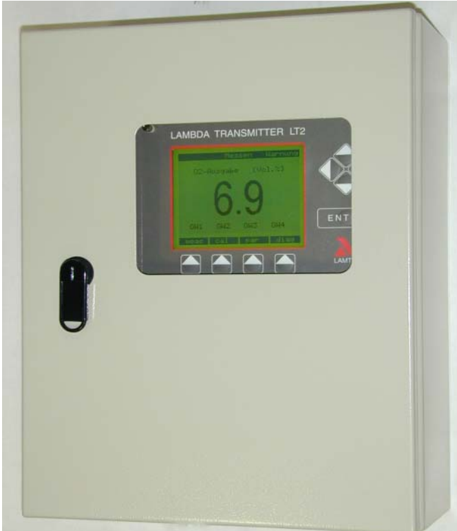
Fig. 3-3 Prevodník Lambda LT2 vo vyhotovení pre zabudovanie na stenu IP 65 400 x 300 x 150 mm (v x š x h) typ 657R102-...
