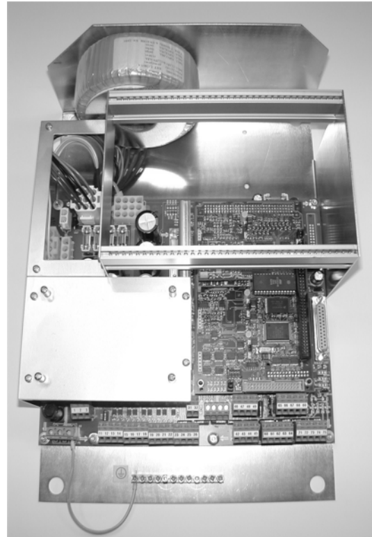
Fig. 3-4 Lambda Transmitter LT2 na placa de montagem 173 x 310 x 270 mm (A x L x P) tipo 657R103-...
