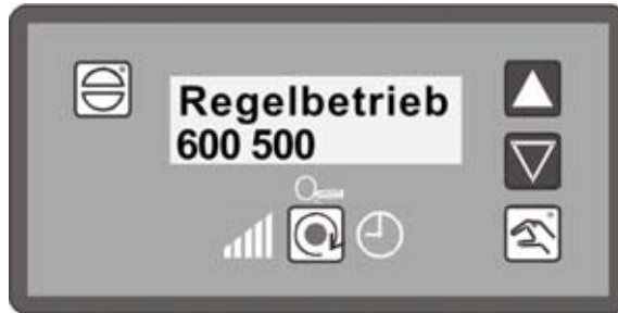
Fig. 8-1 Indication d'état par console cliente
