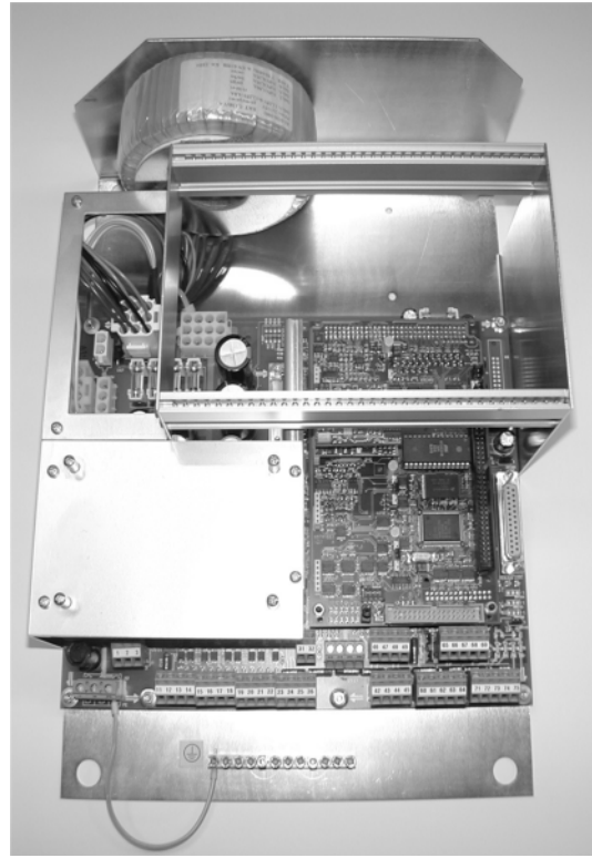
Fig. 3-4 Lambda Transmitter LT2 på monteringsplatta 173 x 310 x 270 mm (H x B x T) typ 657R103-...
