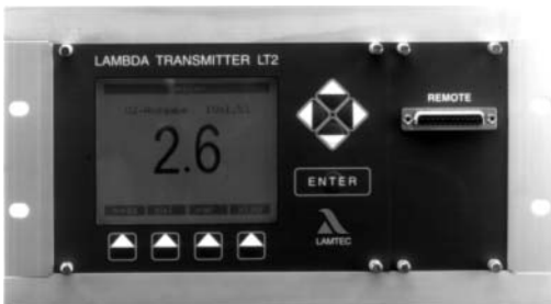
Fig. 3-5 Lambda Transmitter LT2 infällning i tavla 3HE, 50HE 173 x 310 x 270 mm (H x B x T) typ 657R104-...
