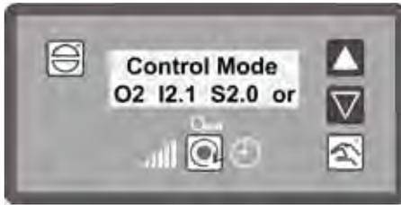
Fig. 7-1 Indicación con regulación de O<sub>2</sub>
