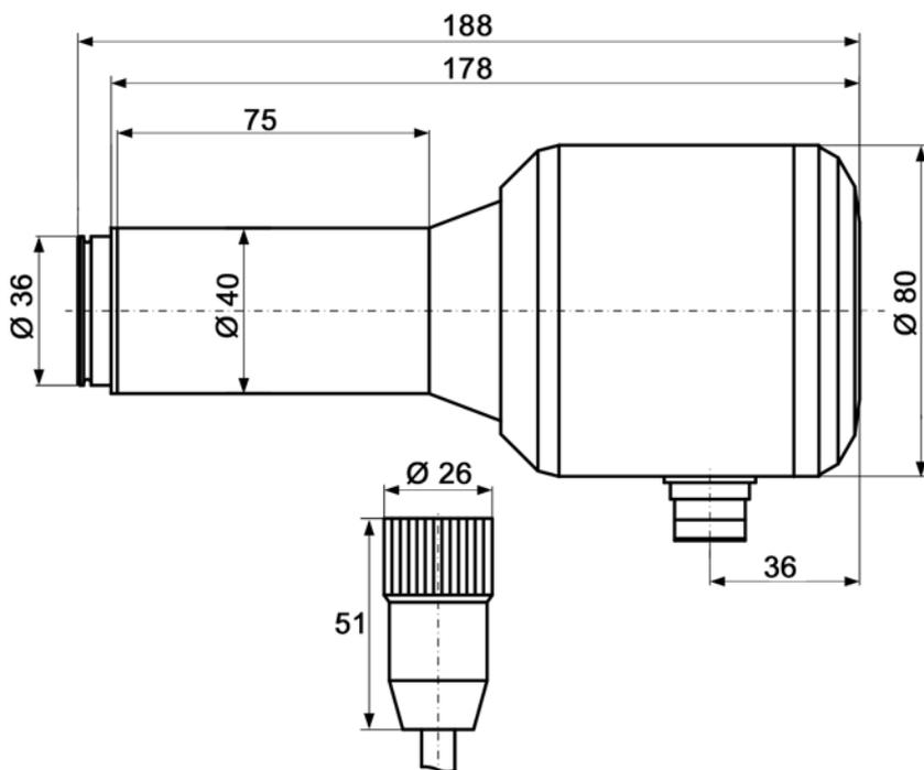
Fig. 4 Maßzeichnung Kompaktflammwächter F200K, F200K Ex-II
