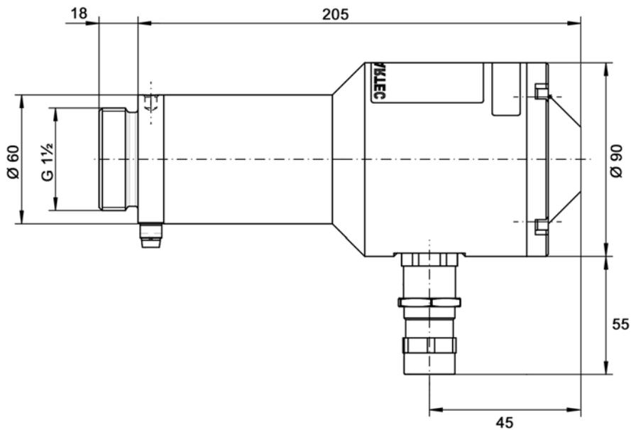
Fig. 6 Maßzeichnung Kompaktflammwächter F200K Ex (für Ex-Zone 1, 21)
