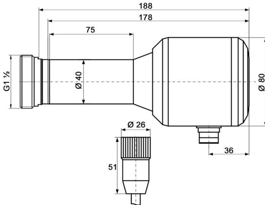
Fig. 2 Maßzeichnung Kompaktflammwächter F200K V, F200K Ex-II V
