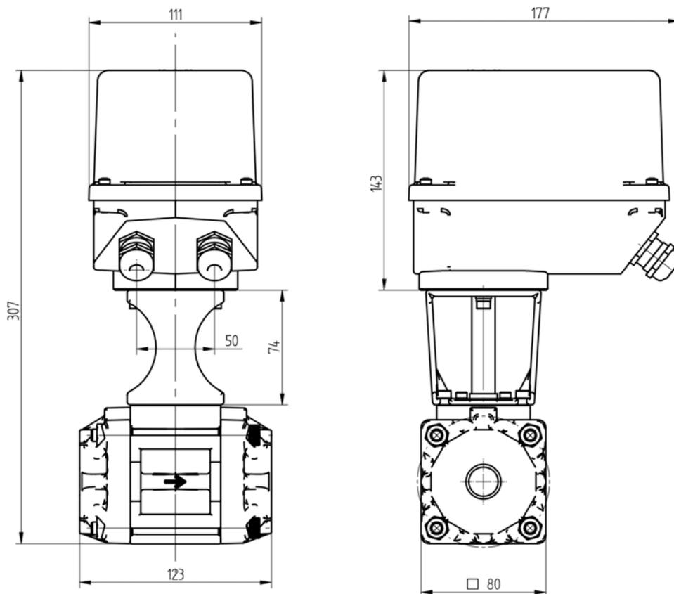
Fig. 4 Maßzeichnung Gasstellglied Typ SVL – 668M2400 montiert auf Stellantrieb (Maße in mm)
