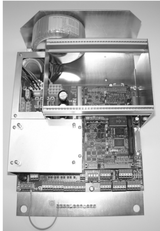
Fig. 3-4 Oddajnik Lambda LT2 na montažni plošči 173 x 310 x 270 mm (V x Š x G), tip 657657R103-...
