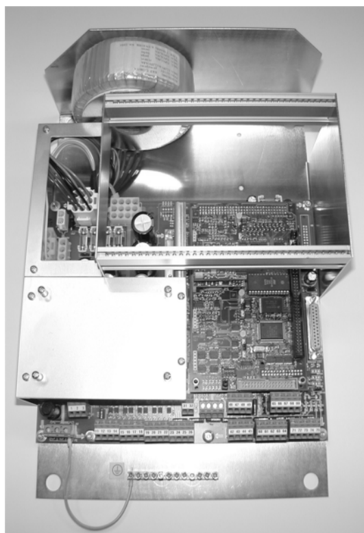
Fig. 3-4 Transmițător Lambda LT2 pe placă de montaj 173 x 310 x 270 mm (H x B x T) tip 657R103-...
