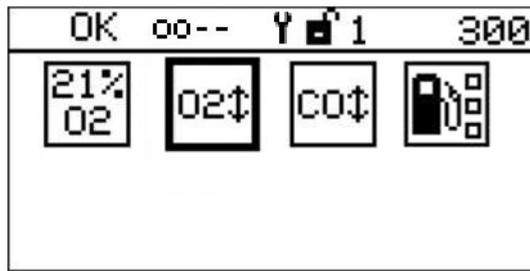
In Abgleich der Sonde O2↓ für O<sub>2</sub> Abgleich.
