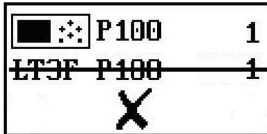
Bei Abbruch oder Timeout wird diese Display angezeigt. Zurück zum Menü EINSTELLUNGEN mit Taste BACK
