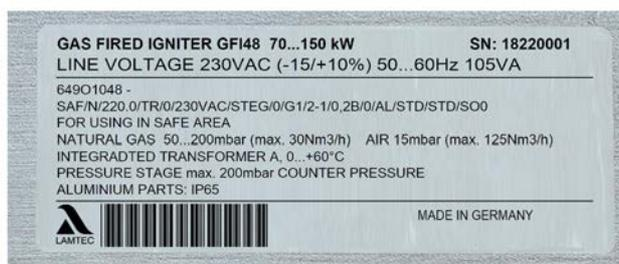
Fig. 3-3 Пример заводской таблички на запальной горелке LAMTEC GFI
