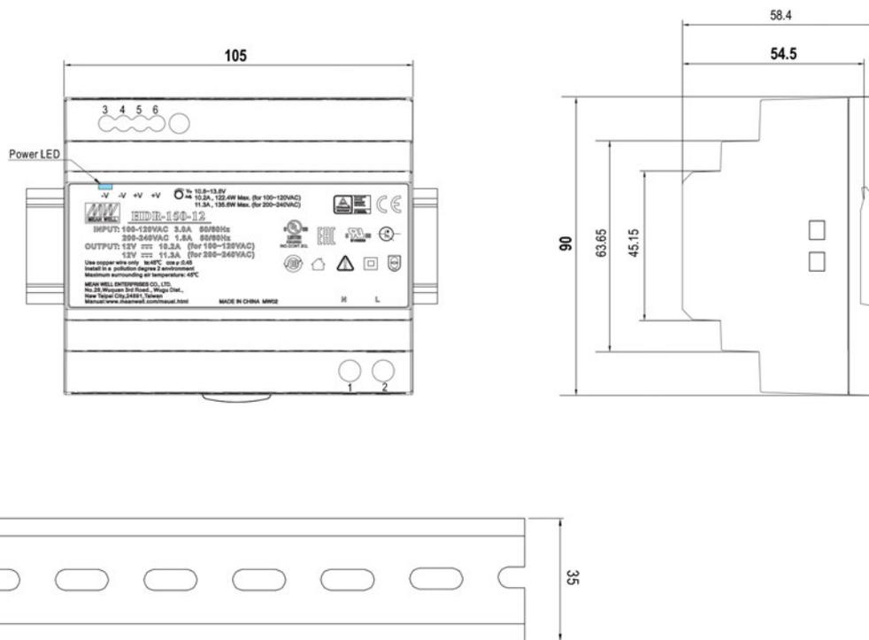
Fig. 2 Dimension bloc d'alimentation PSU24150
