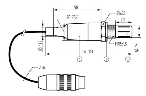
Fig. 1-2 Plan coté Sonde Combinée KS1 sans boîtier
