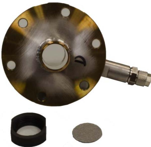
Fig. 7-7 Support du capteur avec filtre capuchon et filtre
