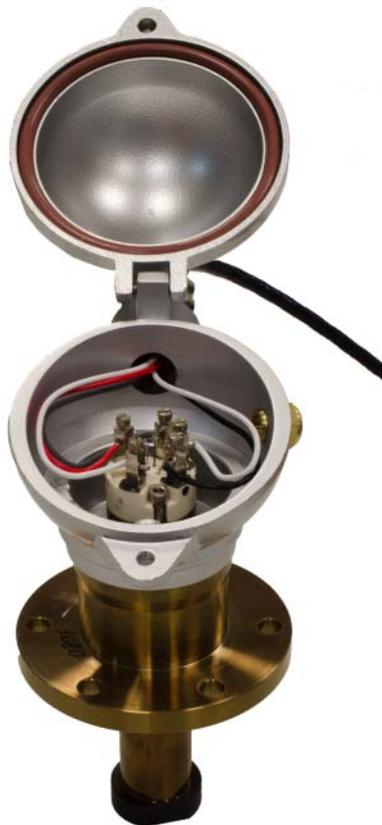
Fig. 7-3 Démonté/ ouvrir la tête de la sonde
