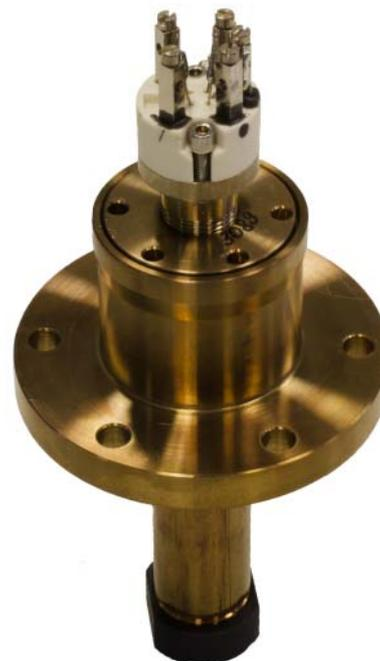
Fig. 7-4 Capteur sans tête de la sonde
