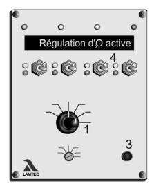
Commutation de l'écran sur le mode de régulation  $d'O_2$ Sélecteur (1) sur "Etat" et commutateur à levier de sélection de canal 3 (4) vers le haut.
