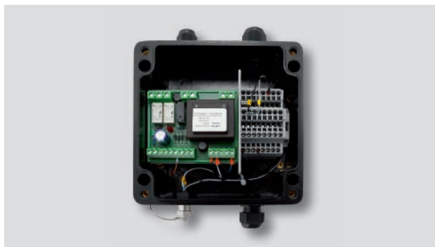
FN30-20 (230 VAC) / FN30-30 (115 VAC) w skrzynce przyłączeniowej z przekaźnikami wyjściowymi 230 VAC / 115 VAC.
