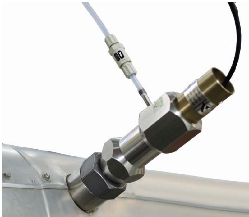
Fig. 5-3 Контрольно-измерительное устройство в канале отработавших газов
