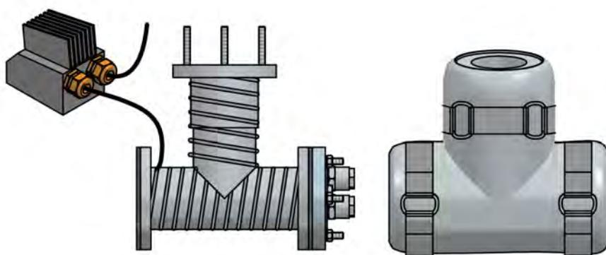
Fig. 2 Adaptateur T avec conducteur chauffant enroulé, raccords pneumatiques, isolation extérieure et joint graphité
