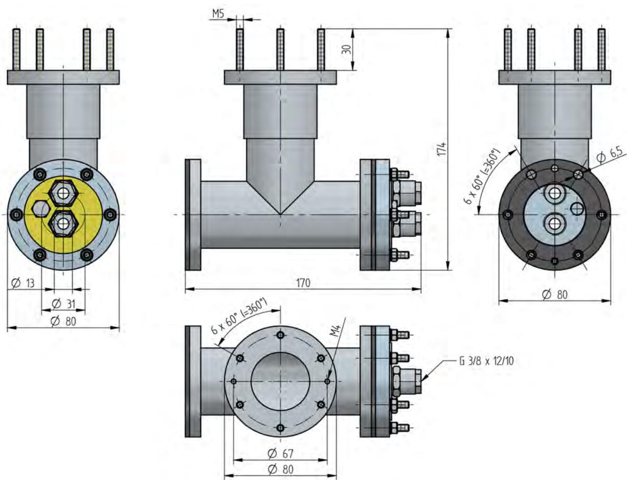
Fig. 1 Adaptateur T pour le logement de sonde pour le mode nettoyage intérieur/extérieur (en mm)
