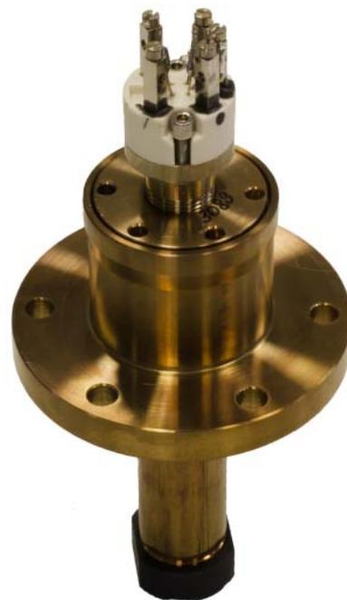
Fig. 7-4 Sensor sin cabezal de la sonda
