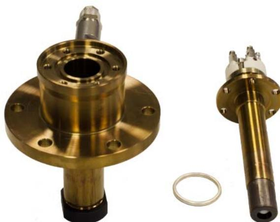
Fig. 7-6 Sensor desmontado con anillo de obturación
