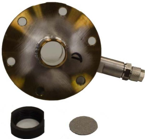
Fig. 7-7 Soporte del sensor con tapa del filtro y filtro
