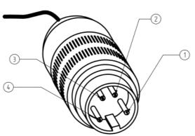
Fig. 1-3 Anschlussbelegung Stecker
