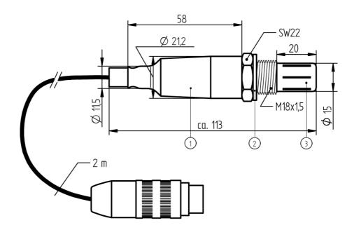
Fig. 1-2 Maßbild Kombi-Sonde KS1 ohne Gehäuse
